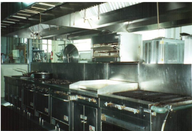
FOTO No. 6 Detalle del área de producción, vista de plancha y salamandra
