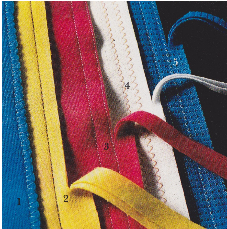
Figura No. 8 Costuras para terminar la orilla de las prendas
