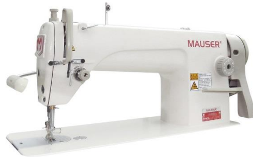
Figura No. 12 Máquina plana
