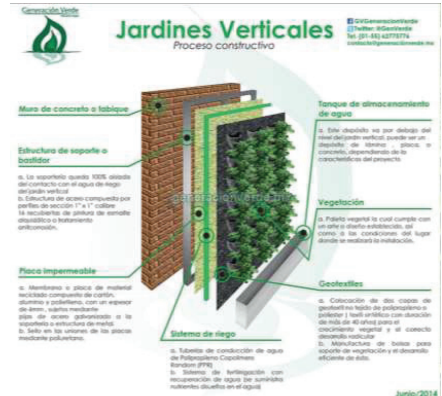
Figura No.6 Construcción de muro verde
