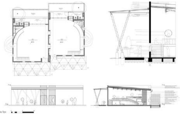
Figura 16. Detalles Constructivos CDI
